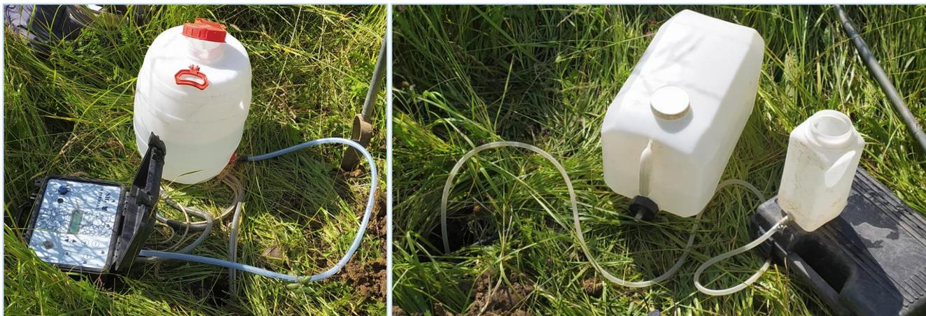
Figure 8 : Installation PERMEA3 et perméamètre type Porchet.
