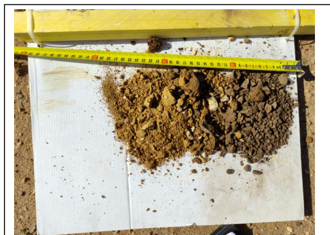
Photographie des prélèvements à la tarière T13 (faciès du calcaire marneux altéré et de calcaire altéré)
