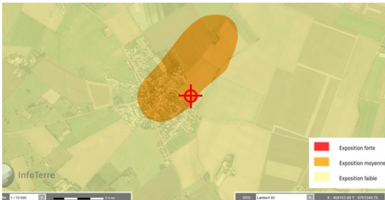
Figure 5 : Cartographie de l'aléa Retrait-Gonflement des Argiles sur le secteur étudié, échelle 1/10 000 (source BRGM)
