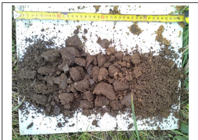
Photographie des prélèvements à la tarière T4 (faciès de terre végétale et de limon sableux)
