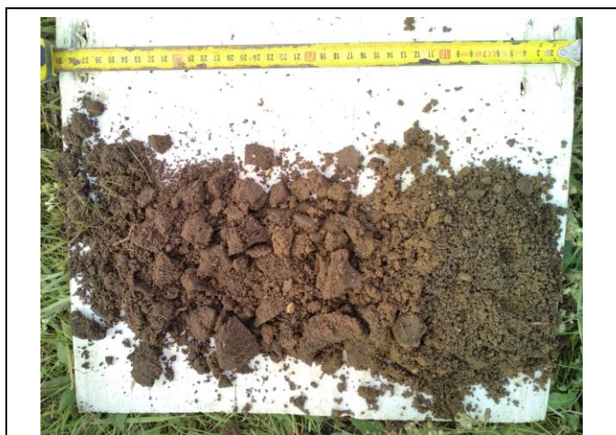
Photographie des prélèvements à la tarière T3 (faciès de terre végétale et de limon sableux)
