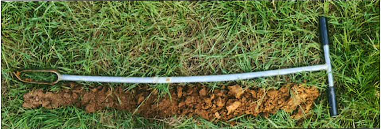
Figure 7 : photographie du sondage n° 5 des échantillons extraits du sol
