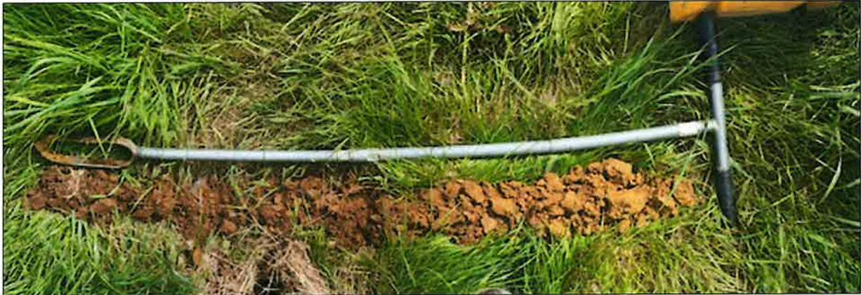
Figure 7 : photographie du sondage n° 2 des échantillons extraits du sol
